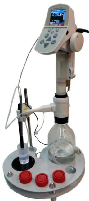
Рисунок 1 - Общий вид титраторов лабораторных AutoTrate 01 и AutoTrate 02 с подставкой с магнитной мешалкой
