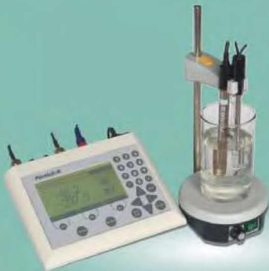
Четырехканальный стационарный pH-метр / иономер с большим графическим ЖК-дисплеем.
